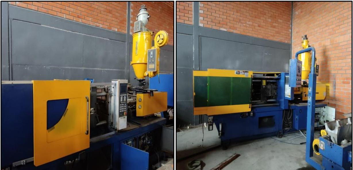
Foto: Extrusora e Injetora de plástico.
